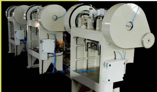
PRESSE ELECTRO-PNEUMATIQUE MODELE SCM 20 (20 TON) – SCM 40 (40 TON) – SCM 80 (80TON) fabriqué exclusivement pour ce type de produit
