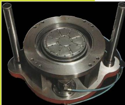
OUTILS POUR RECIPIENTS SMOOTHWALL ( parois lisses), pour barquettes plus rigides et un plus beau design . Ceux sont des produits avec de l'aluminium laqué ou non, idéale pour un usage immédiat, ils peuvent être fermé hermétiquement avec une pellicule ou un couvercle en aluminium. Ces récipients sont utilisés principalement pour les industries agroalimentaire, pour les compagnies aériennes , elles ont des dimensions et épaisseurs différentes.
